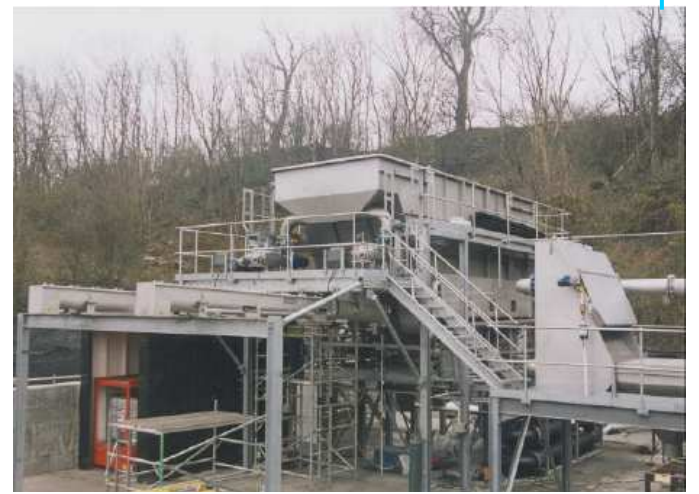
Dégraissage par flottation Grease removal by flotation Prétraitement physico-chimique sur flottateur Physico-chemical pre-treatment by flotation
