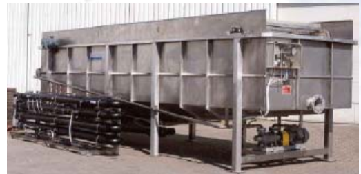
Flottateur à air dissous PWL / CPL équipé d'un floculateur PFL
