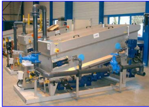
Montage sur Skid
