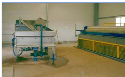
Pré épaississement avant déshydratation par filtre à plateaux
