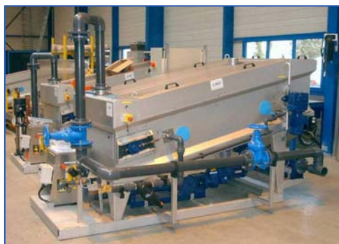
Montage sur Skid
