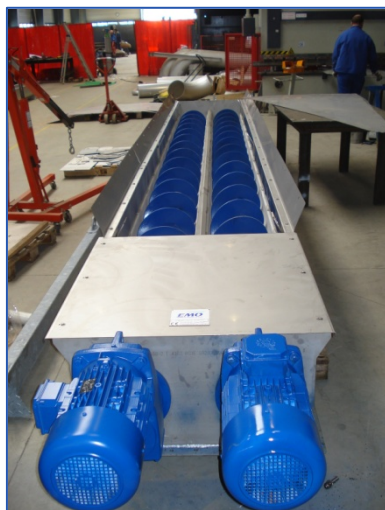
Double spire pour l'évacuation de la boue provenant d'un filtre à plateaux
