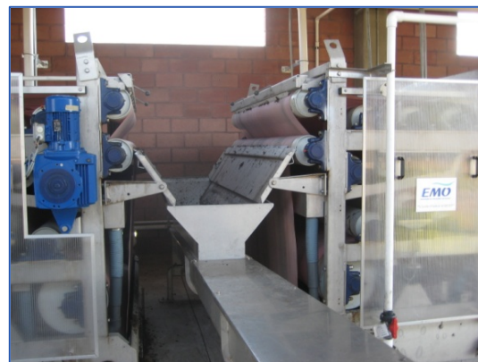
Une vis convoyeuse pour deux filtres à bandes
