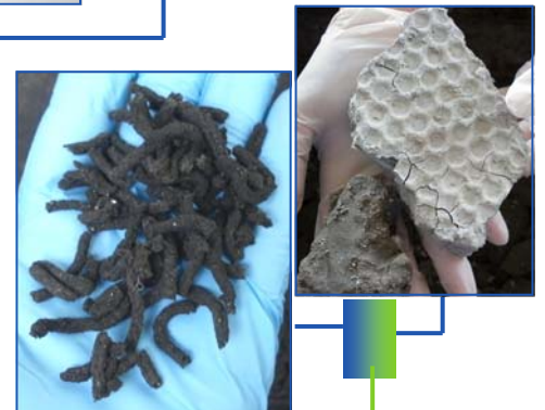
Séchage de boues déshydratées
